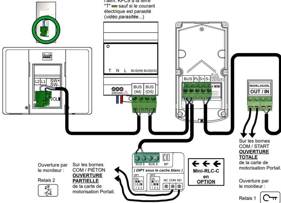
Ne pas connecter l'alim. KPC9 à la terre "T" sauf si le courant électrique est parasite (vidéo parasitée...)
