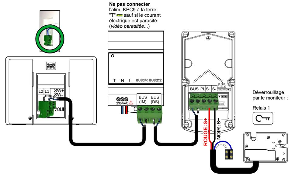
Ne pas connecter l'alim. KPC9 à la terre "T" sauf si le courant électrique est parasite (vidéo parasitée...)
