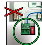
Ne pas connecter l'alim. KPC9 à la terre "T" sauf si le courant électrique est parasité (vidéo parasitée...)
